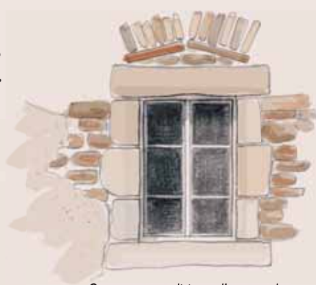
Ouverture traditionnelle avec des encadrements en pierre travaillée et arc de décharge
